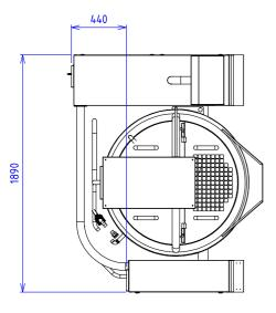
**ELEC:** Puissance Electrique : 37 kW Raccordement Elec : 400V Tri + terre Fréquence : 50Hz
