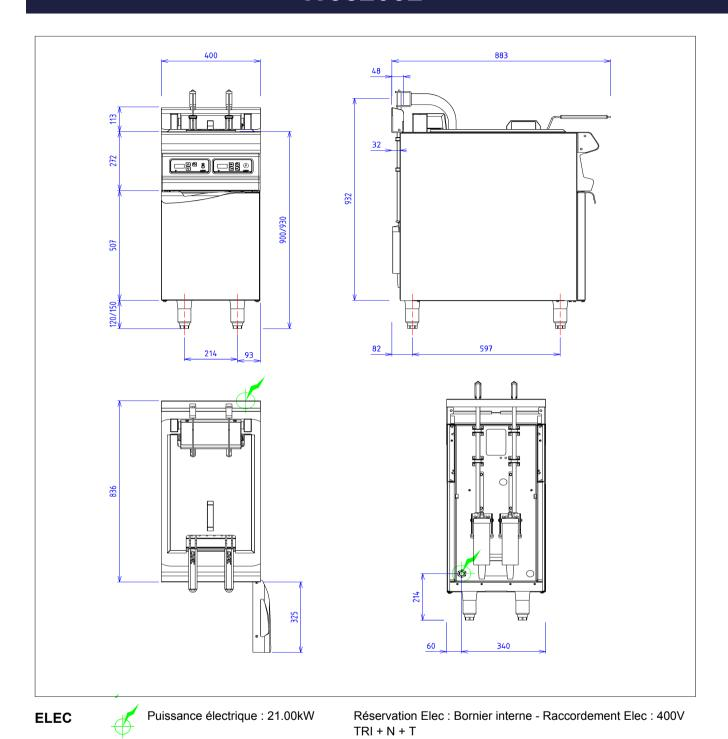
Appareils électriques conformes à la norme EN 60-335\*
