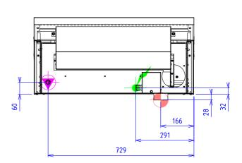
**GAZ:** • Puissance gaz : 10kW Raccord gaz: 15/21 conique
