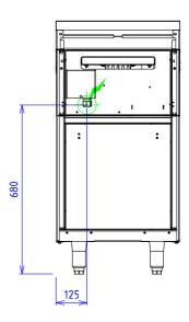
**ELEC:** Puissance Electrique : 3 kW Réservation Elec : Bornier interne Raccordement Elec : 400Vx3+T
